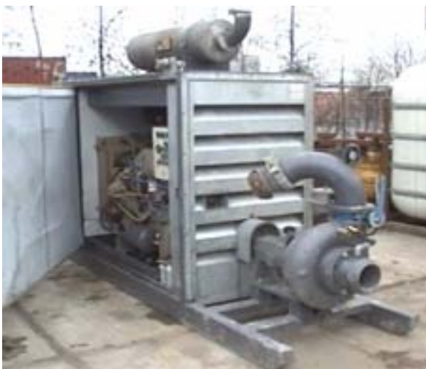
Anlage PH6x5D mit 100 kW Diesel Leistung 250 m 3 /St – 7 bar
